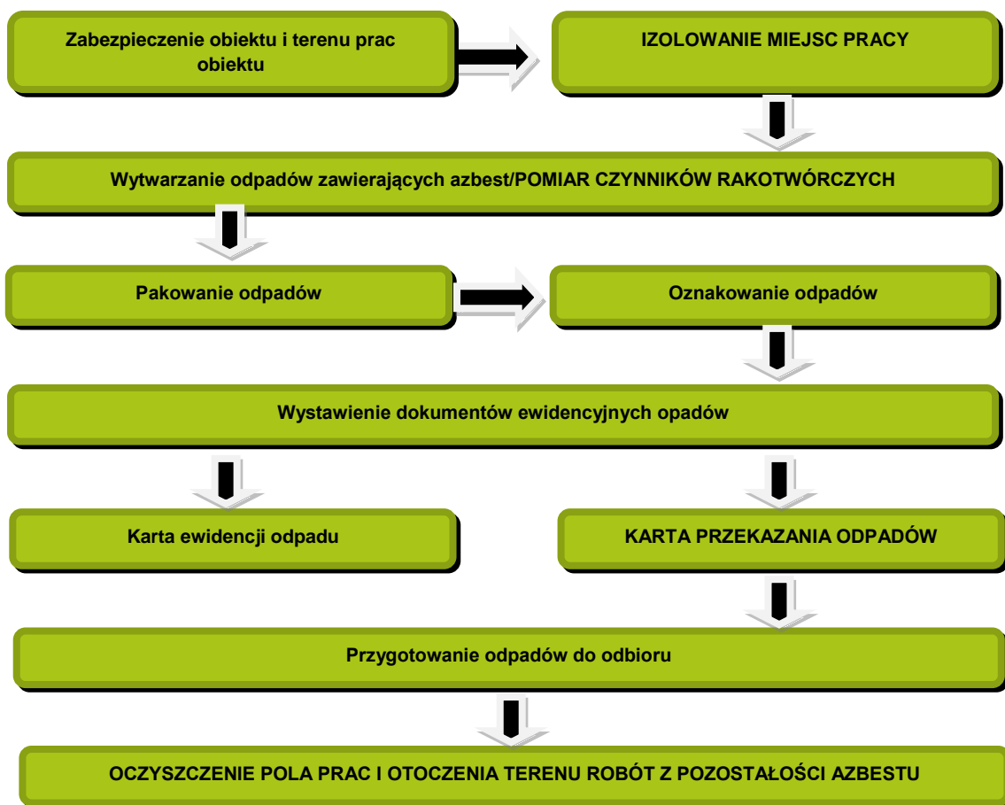
Rysunek 10. Schemat procedury dotyczącej prac polegających na usuwaniu wyrobów zawierających azbest, wytwarzania odpadów niebezpiecznych wraz z oczyszczaniem obiektu/terenu/instalacji
